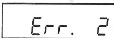
Chybové hlášení (pouze v případě chybového stavu – 2s)
